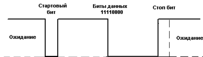
Рис 1. Передача байта по USART.
