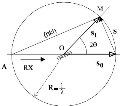
Le cristal diffracteur placé en O reçoit un faisceau de vecteur d'onde  $s_0$ . Soit la sphère dite « sphère d'Ewald » de centre O et de rayon  $R = 1/\lambda$ . Le faisceau incident AO traverse la sphère en I.
