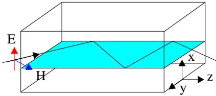
Une onde électromagnétique (OEM) plane incidente se propageant dans un milieu diélectrique et rencontrant un plan conducteur, donne naissance à une onde réfléchie. Les conditions de continuité à la surface de séparation entre un milieu diélectrique et un conducteur parfait imposent que la composante tangentielle du champ électrique et la composante normale du champ magnétique soient nulles.
