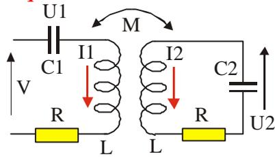
On considère deux circuits R, L, C série couplés par induction mutuelle. Les deux inductances sont identiques ainsi que les résistances. Le circuit de gauche est excité par une tension  $v(t)$  sinusoïdale. On étudie le courant dans chaque circuit.
