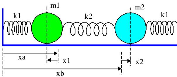
Le plus simple des systèmes couplés est formé par deux masses  $m_1$  et  $m_2$  pouvant glisser sans frottement sur un plan horizontal et par deux ressorts de raideur  $k_1$ . Les deux masses sont également reliées par un ressort de raideur  $k_2$ . On négligera les masses des ressorts. Les abscisses des positions d'équilibre des masses sont  $x_A$  et  $x_B$ . Les déplacements des masses sont  $x_1$  et  $x_2$ . Le mouvement des deux masses
