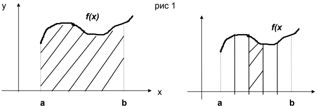
Формально процедура численного интегрирования заключается в том, что отрезок  $[a, b]$  разбивается на  $n$  частичных отрезков, а затем подынтегральная функция заменяется легко интегрируемой функцией, интерполирующей значения подынтегральной функции в точках разбиения.
