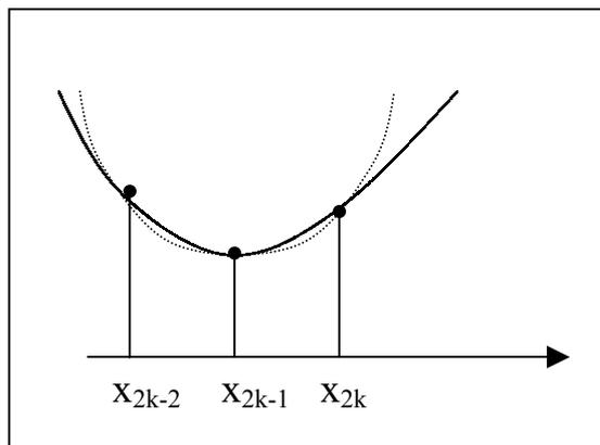
Произведем квадратичную интерполяцию данной подынтегральной функции на каждом из отрезков разбиения, т.е. заменим дугу графика подынтегральной функции дугой параболы (рис.4).
